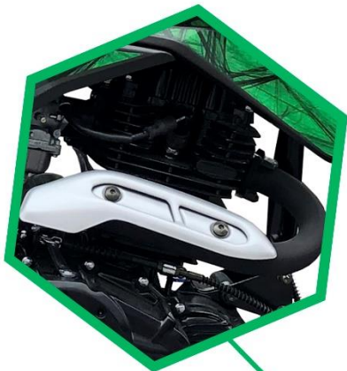
Стальная выхлопная труба с защитой
